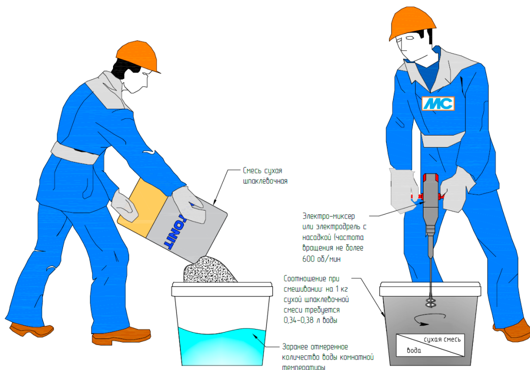
Рис. 13. Организация работ по затворению сухой шпаклевочной смеси
